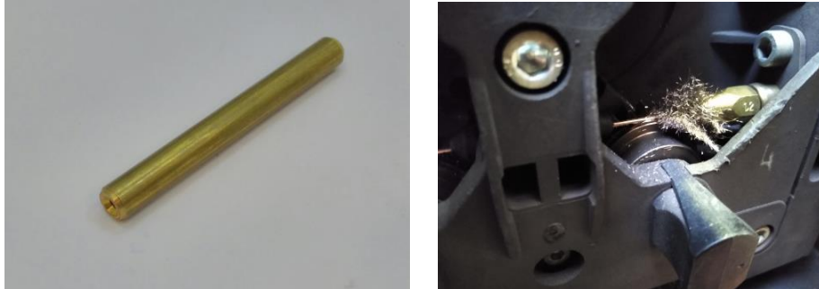
Fotoğraf-4 Kılavuz borusu ve aşınmış tel talaşları
