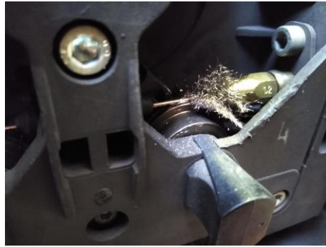
Fotoğraf-1 Baskı ayarının fazla olması sonucu bakır dökülmesi gözlenebilir.
