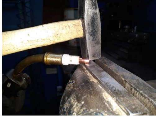
Fotoğraf-9 Kontak meme kesinlikle çekiçle dövülerek kullanılmamalıdır!
