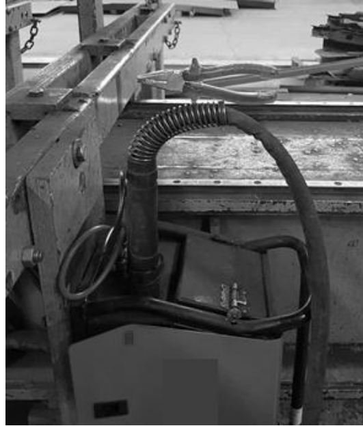
Fotoğraf-6 Hatalı torç formu
